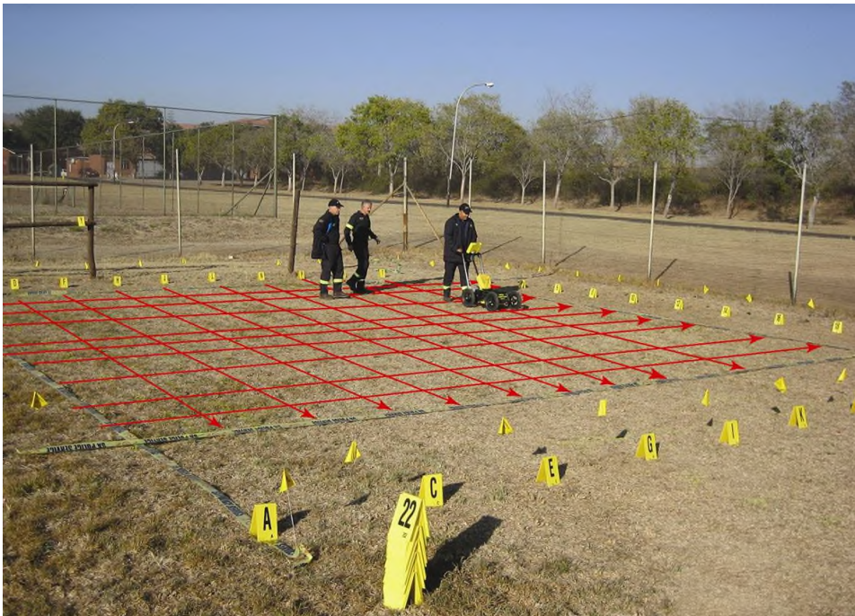
Abbildung 9-2: Beispiel eines Ortungsrasters. Die roten Linien wurden überlagert, um die Konzeption zu veranschaulichen.
